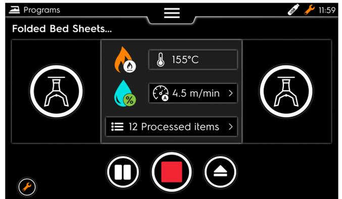
**3** Puede utilizar la máquina y ver los diferentes estados de las abrazaderas del alimentador o el calentamiento y la velocidad.
